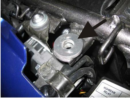
3. Legen Sie die Distanzen 4mm hoch wie in Bild3 auf die vorderen Befestigungspunkte der Gepäckbrücke am Heckrahmen.
