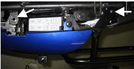
5. Platzieren Sie Träger links und rechts wie in Bild5 am Fahrzeug und schrauben Sie beide (ohne die Schrauben festzuziehen) leicht an den hinteren Befestigungspunkten an (Bild6). Verwenden Sie hierfür
