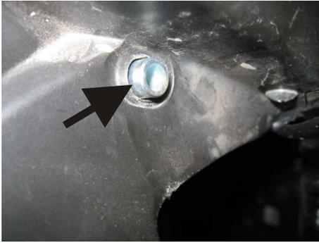
4. Platzieren Sie die Distanzen 7,5mm hoch in den Aussparungen am Kennzeichenträger wie in Bild4.
