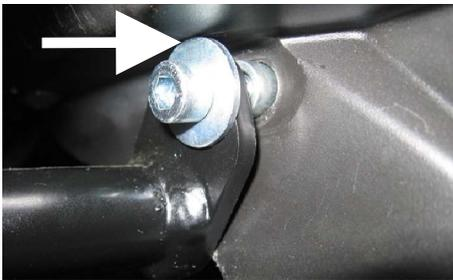
**Achten Sie darauf, dass die vorderen Laschen der Träger jeweils hinter den Rohren der Fußrastenausleger anliegen! Evtl. muss an den U-Scheiben M6 groß die obere Kante etwas abgenommen oder umgebogen werden, damit diese nicht gegen den Kennzeichenträger drückt.**
