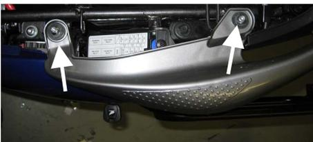
6. Legen Sie die Gepäckbrücke auf die Distanzen und die Laschen der Träger und schrauben Sie diese dann mit den beigelegten Linsenkopfschrauben M8x30 leicht an (Bild7). Noch nicht festziehen!
