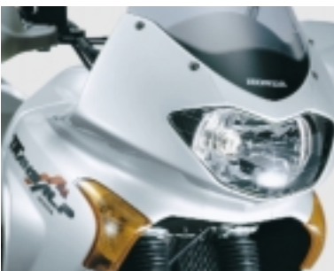
Die bündig eingelassenen Blinker sind nach vorn und zur Seite gut sichtbar.
